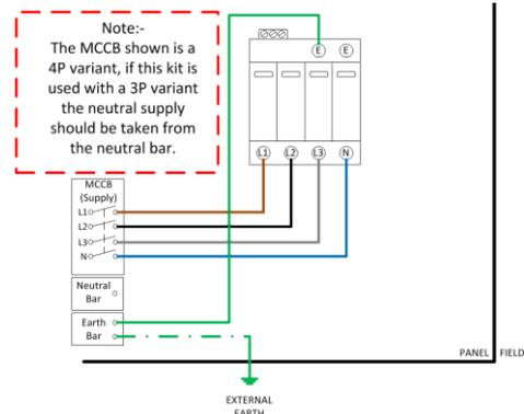
**Fig. 2 B - Surge Arrestor Wiring Details**
