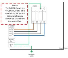
Fig. 2 B - Surge Arrester Wiring Details
